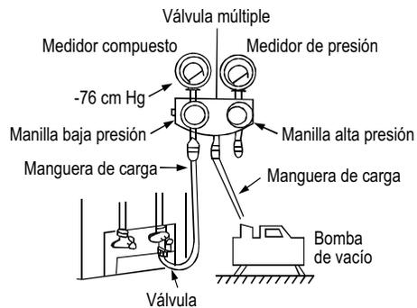
7. Retire la manguera de carga de la manguera de carga de baja presión.
