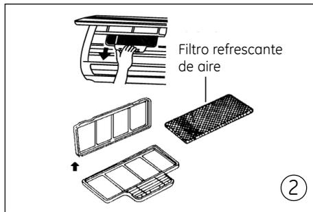
4. Retire el filtro refrescante de aire del marco de soporte (en algunos modelos). El filtro opcional incluye recolector de polvo de plasma/Filtro de iones de plata/Biofiltro/Filtro de vitamina C/Filtro purificador de aire, etc. Los procedimientos de remoción e instalación son ligeramente diferentes. Vea las ilustraciones marcadas 1 y 2.
