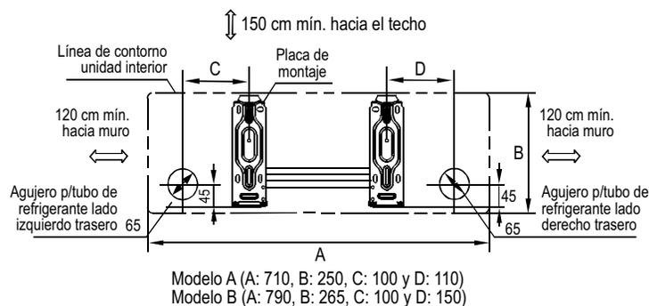
1. Instale de manera horizontal la placa de montaje contra los elementos estructurales del muro. Deben dejarse claros alrededor de la placa de montaje.
