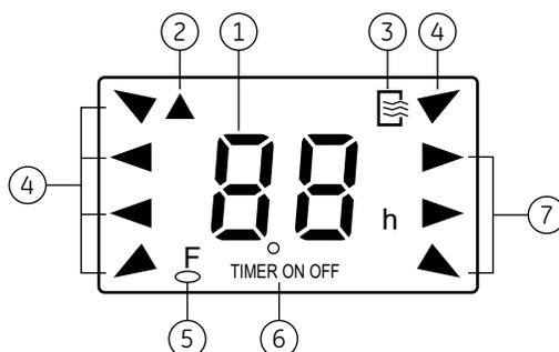
1. Área de **PANTALLA DIGITAL**: Esta área muestra la temperatura y en la función de temporizador, muestra si está encendido o apagado. Si se encuentra en el modo de ventilador no aparece nada.
