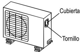
2. Conecte los cables a las terminales según se identifican con sus números respectivos en el bloque de terminales de las unidades interior y exterior.
