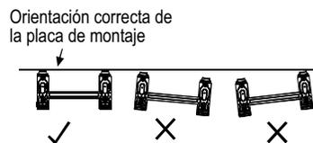
**NOTA:** Instale la placa de montaje y taladre agujeros en el muro de acuerdo a la estructura del muro y puntos de montaje. La placa de montaje incluida difiere de acuerdo con el modelo como se muestra en las ilustraciones. Las dimensiones se especifican en mm a menos que se indique otra cosa.
